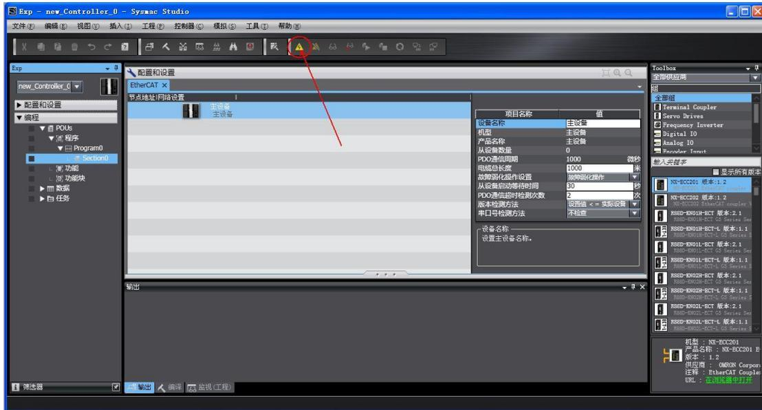
4) 在右侧“配置和设置”列表中选择“Ethercat”,在 B 处可以看到相应的控制器图标。
