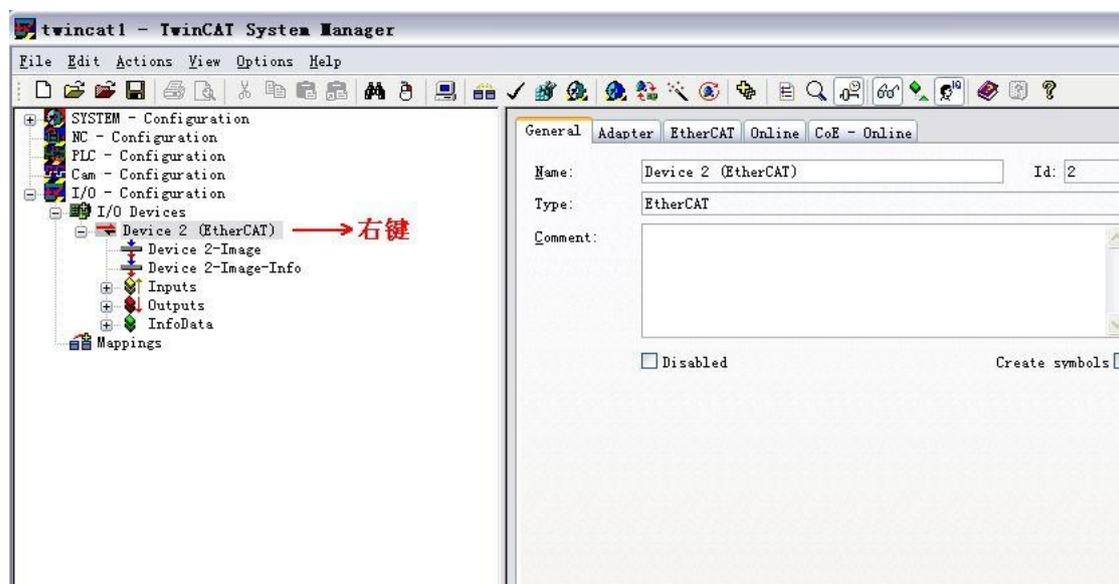
2) 如果网关与 PLC 连接正常，则系统可以自动搜索到的 Compact67\_Slim 从站，并且可以看到具体的模块连接。如下图：
