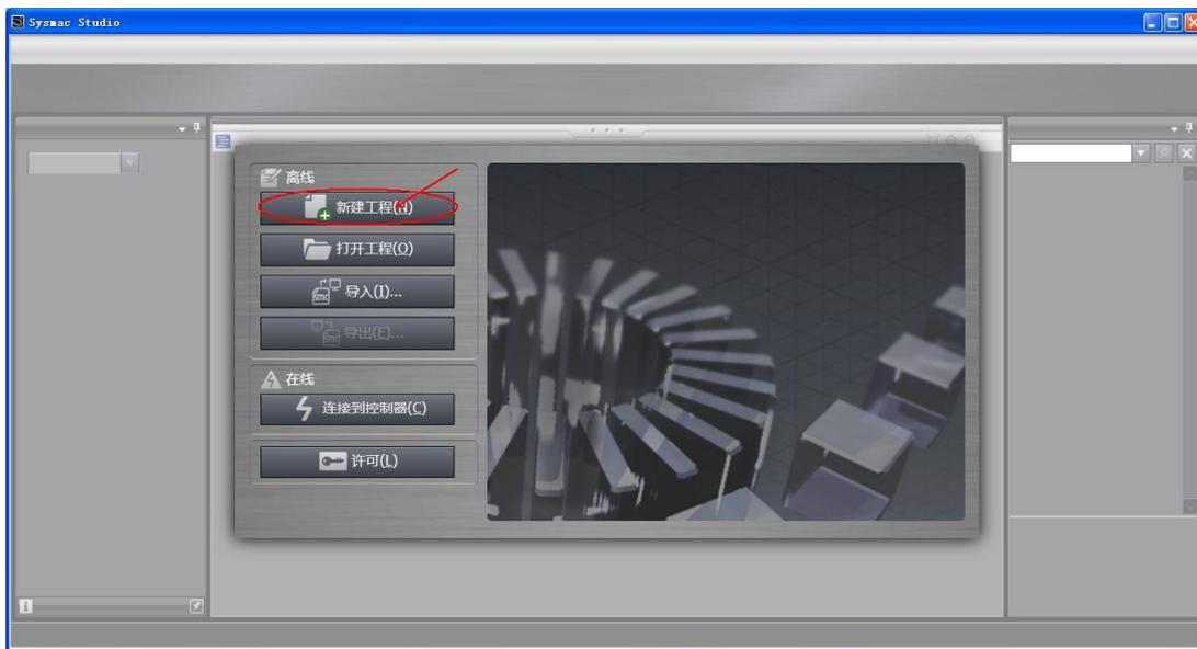
2) 根据 PLC 型号填写相应信息，点击“创建”。
