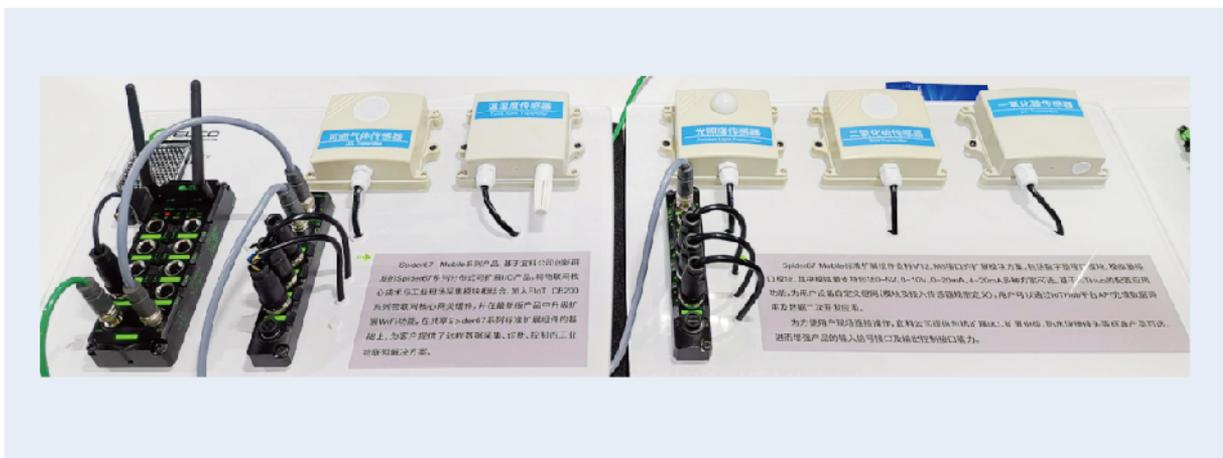
Spider67 Mobile产品网关具备逻辑编程能力，配合IoT Hub™的Workflow工具化软件，可以实现基础I/O通道定义及配置、I/O逻辑定义及配置，实现数字量及模拟量信号采集、上传，本地支持边缘逻辑处理能力，实现阈值判断、输出及介入控制，其中输入支持扩展可以连接水（液）位计、温湿度传感器、各类气体检测传感器、压力、振动、电流电压等多种传感器，支持0-10V、0-20mA、4-20mA多种通道类型选择。
