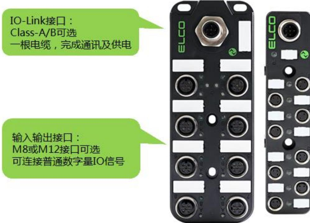
Compact67 系列 IO-Link 信号集线器，可作为 IO-Link 子站与宜科或其他品牌的 IO-Link 主站相连接，符合 IO-Link v1.1 标准，支持 COM2 (38.4kbps) 通讯速率。IO-Link 主站模块的每个 IO-Link 接口均可扩展一个 IO-Link 集线器用来采集输入输出信号，即 8 端口的 IO-Link 主站模块加 8 块 IO-Link 集线器，最多可以连接 128 个开关量信号。
