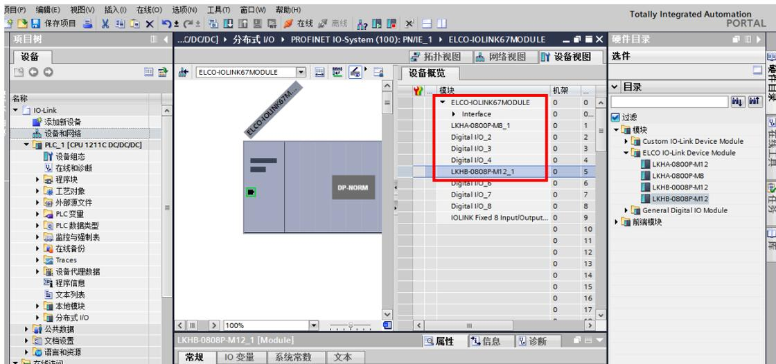
10) 保存编译后，将配置的组态下载到 PLC 中完成组态工作。
