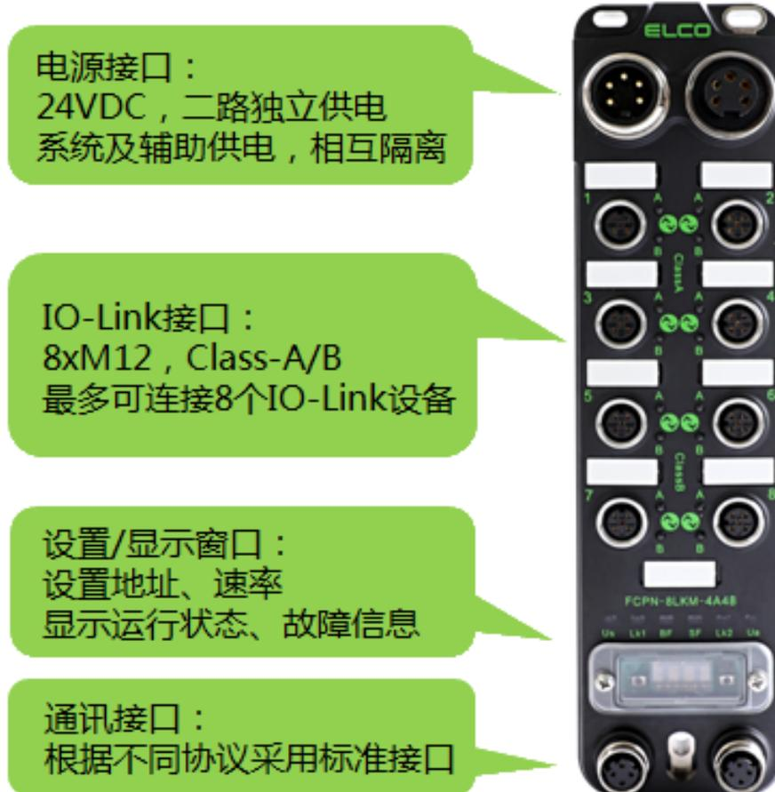
每个 Compact67 系列 IO-Link 主站模块占用一个 Profinet 从站地址，根据型号不同，最多的可以连接 8 路 IO-Link 设备，根据具体需求选择 Class-A 或 Class-B 接口类型的模块。
