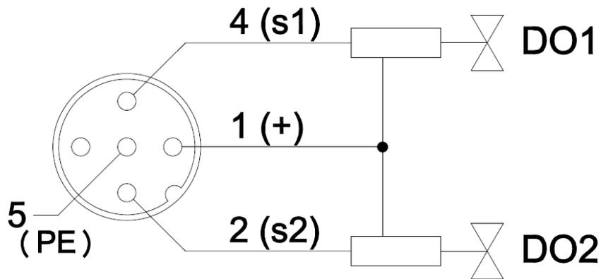
f) 单输入信号——即 1 个连接器接 1 个数字量输入信号，IO-Link 集线器中 LKHA-0800P-M8、LKHA-08UP-M8 等型号产品支持此形式连接。
