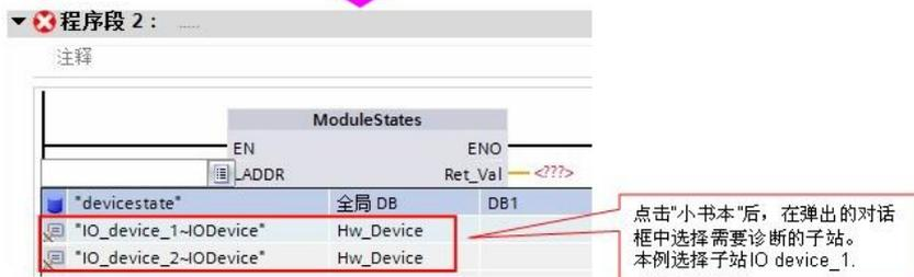
3) 本例中将 MODE 设置为 2，STATE 填写上述定义的全局数据块数组。
