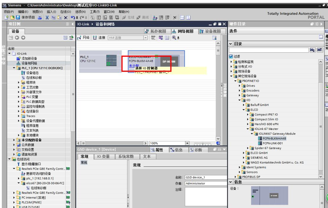
c) Compact67 系列 IO-link 主站与 PLC 完成通讯的连接。
