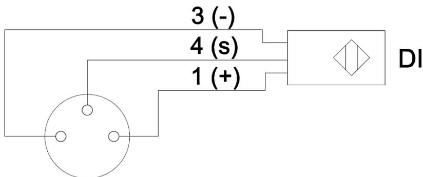
g) 单输出信号——即 1 个连接器接 1 个数字量输出信号，IO-Link 集线器中 LKHA-08UP-M8 等型号产品支持此形式连接。
