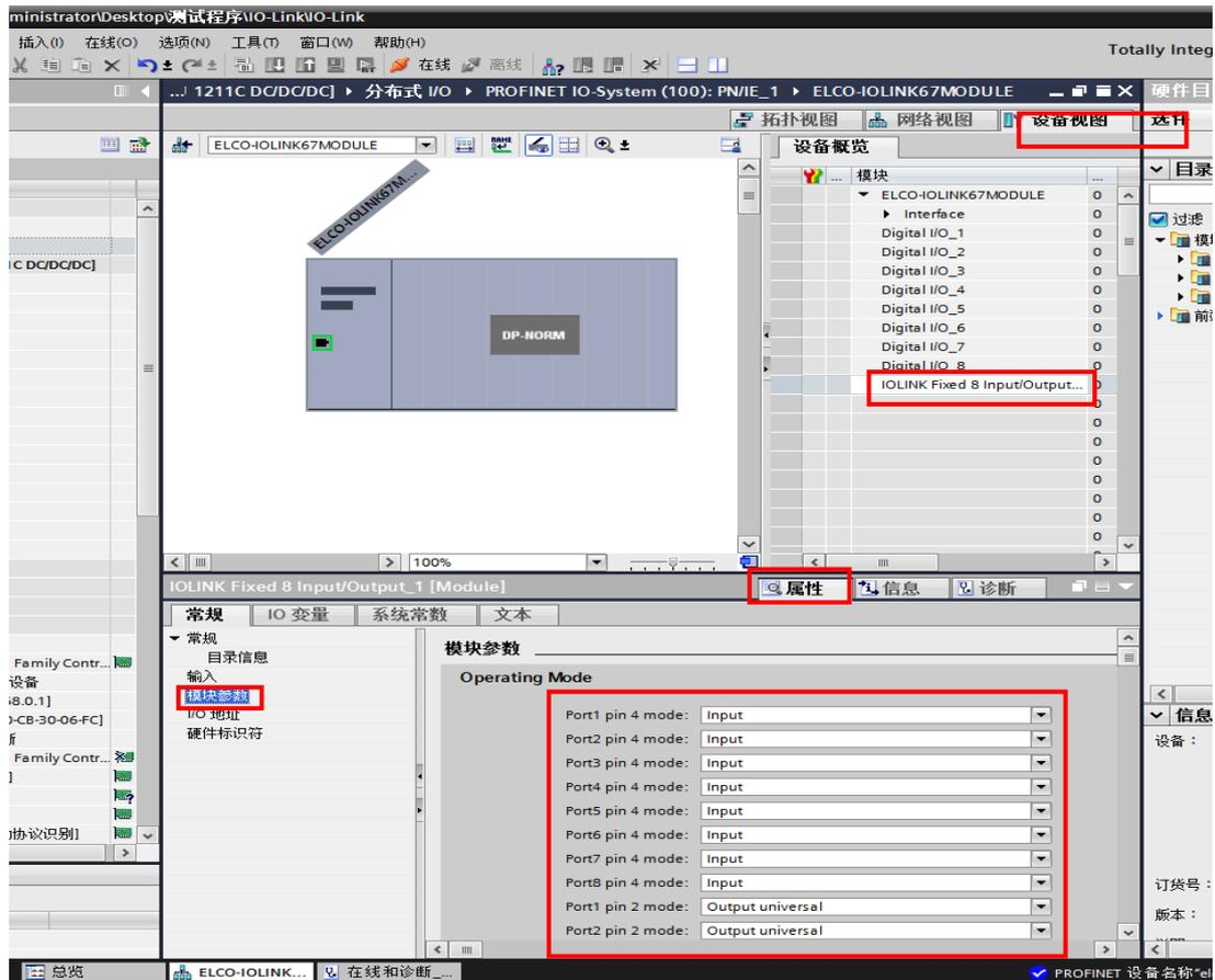
对于 Compact67 系列 IO-Link 主站 FCPN-8LKM-4A4B 来说，接口 Port 1~Port 8 的 pin4 有“Input”、“Output”、“IO-Link”三种工作模式供用户选择，接口 Port 1~Port 8 的 pin2 有“Input”、“Output”、“Output universal” 三种工作模式供用户选择。
