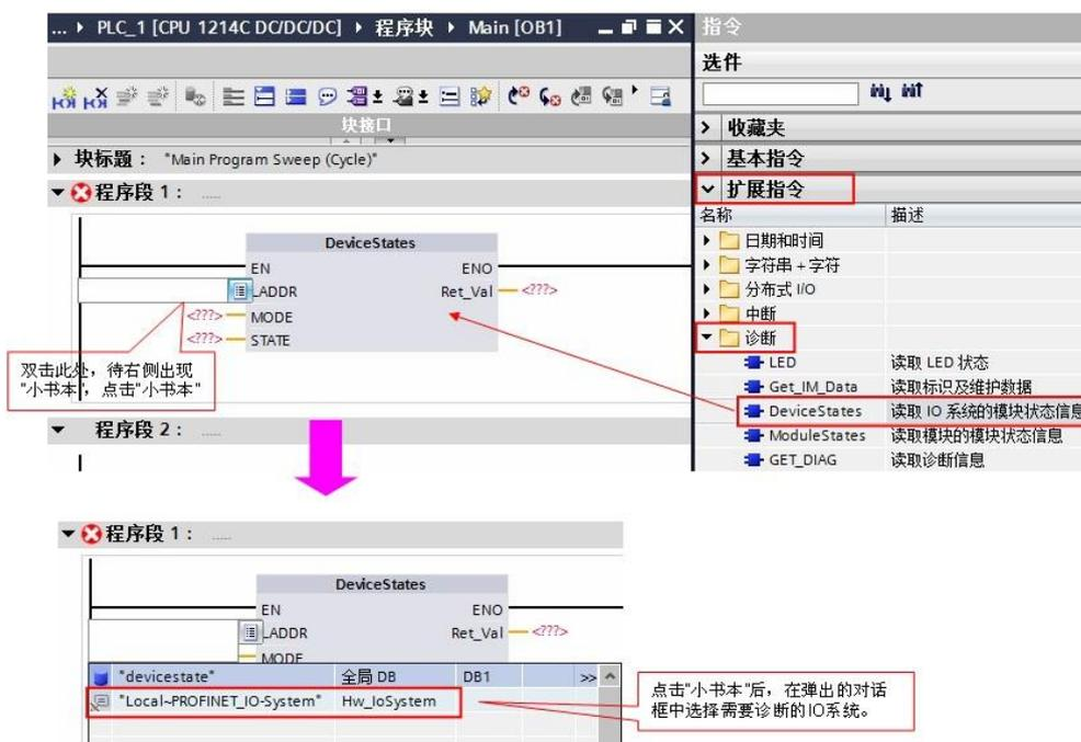
3) 本例中将 MODE 设置为 2，STATE 填写上述定义的全局数据块数组。
